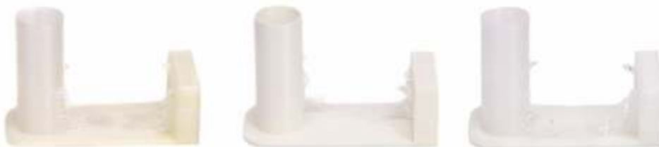
Foto 3: Zkušební výtisk z PVA, PA a TPU (zleva doprava) po 4 dnech v relativní vlhkosti = 70%.
