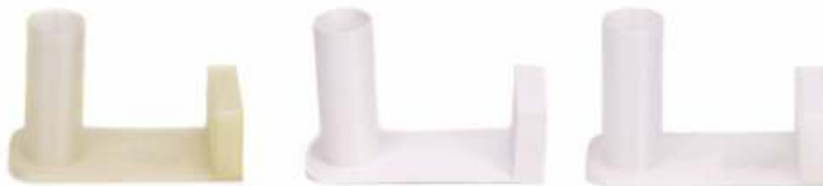
Foto 1: Zkušební výtisk z PVA, PA a TPU (Zleva doprava) po 4 dnech v relativní vlhkosti <10%.
