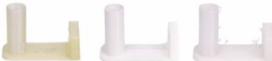
Foto 2: Meze tisknutelnosti (zleva doprava), PVA při relativní vlhkosti 40%, PA při relativní vlhkosti 30% a TPU při relativní vlhkosti 12%.
